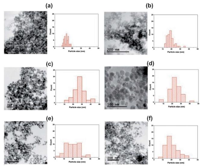
ig. 1 TEM images and particle size distributions of (a) Si-H (b) Si-H-UV (c) Ti-H (d) Ti-H-UV (e) 9Ti-1Si-H (f) 9Ti-1Si-H-UV.
