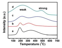
Fig. 4 TPD-NH $_3$  profiles for (a) CP-150-5, (b) CP-150-3, (c) CP-150-0.4M5, and (d) CP-150-0.6D3.
