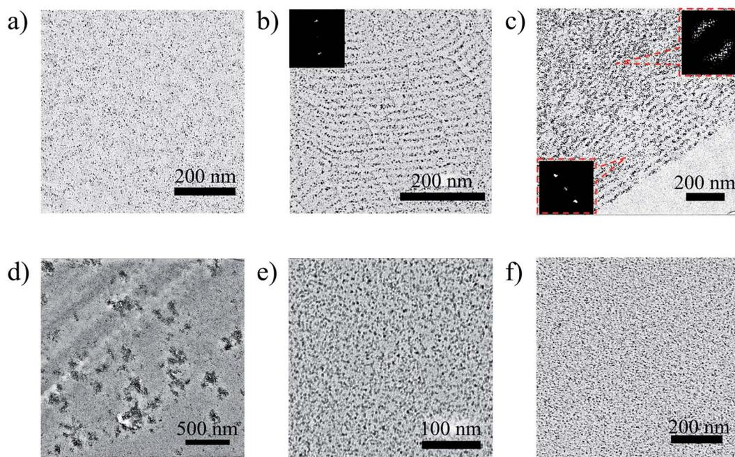
Fig. 6 TEM images of the LC polymer-QD composites: (a)  $V_{60}$ - $LC_{40}$ - $V_{60}$ , (b)  $V_{120}$ - $LC_{40}$ , (c)  $V_{120}$ - $LC_{100}$ , (d)  $V_{20}$ - $LC_{40}$ - $V_{20}$ , (e)  $LC_{20}$ - $V_{40}$ - $LC_{20}$ , (f)  $V_{60}$ - $LC_{40}$ .
