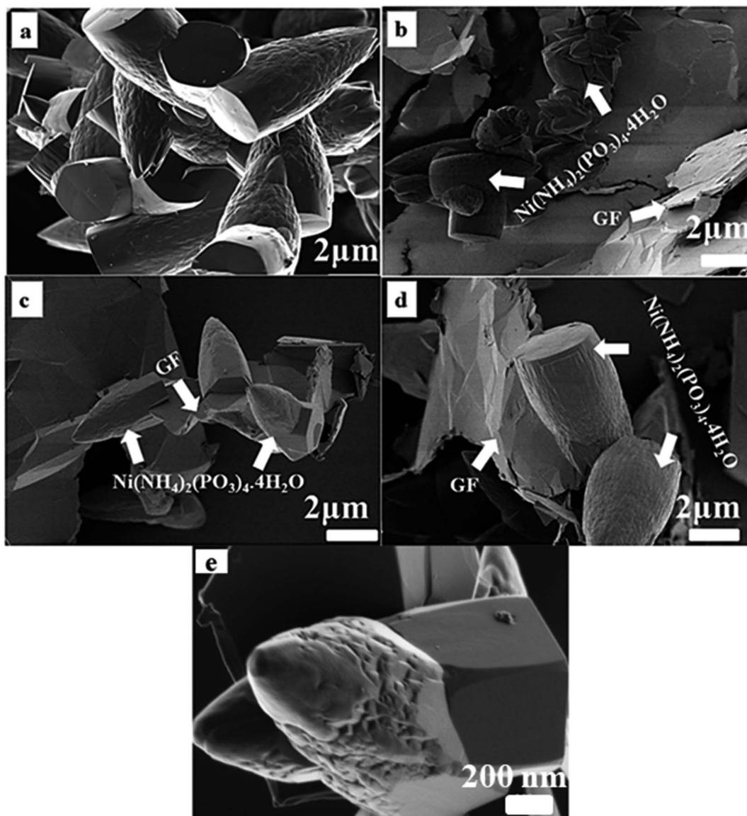
Fig. 3 SEM images of (a)  $\text{Ni}(\text{NH}_4)_2(\text{PO}_3)_4 \cdot 4\text{H}_2\text{O}$ , (b)  $\text{Ni}(\text{NH}_4)_2(\text{PO}_3)_4 \cdot 4\text{H}_2\text{O}/30 \text{ mg GF}$ , (c)  $\text{Ni}(\text{NH}_4)_2(\text{PO}_3)_4 \cdot 4\text{H}_2\text{O}/60 \text{ mg GF}$ , (d)  $\text{Ni}(\text{NH}_4)_2(\text{PO}_3)_4 \cdot 4\text{H}_2\text{O}/90 \text{ mg GF}$  and (e) high magnification SEM of  $\text{Ni}(\text{NH}_4)_2(\text{PO}_3)_4 \cdot 4\text{H}_2\text{O}/60 \text{ mg GF}$ .
