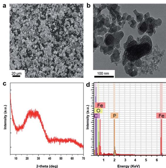
Fig. 1 (a) TEM, (b) SEM, (c) XRD and (d) EDX of FePO<sub>4</sub>.
