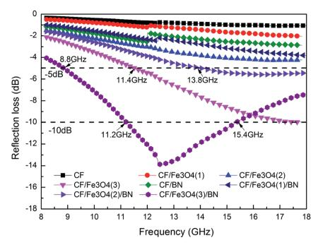
Fig. 11 EM wave absorption properties of CF, CF/BN, CF/Fe $_3O_4(1)$ , CF/Fe $_3O_4(2)$ , CF/Fe $_3O_4(3)$ , CF/Fe $_3O_4(1)$ /BN, CF/Fe $_3O_4(2)$ /BN, and CF/Fe $_3O_4(3)$ /BN composites.
