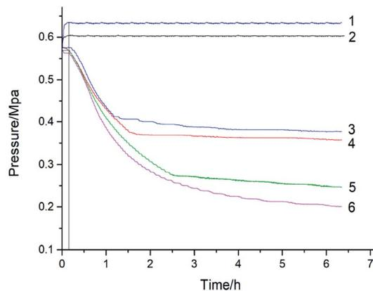
Fig. 3 Pressure versus time for cinnamaldehyde, 1 –  $\text{N}_2$ ,  $353 \text{ K}$ ; 2 –  $\text{N}_2$ ,  $308 \text{ K}$ ; 3 –  $\text{O}_2$ ,  $308 \text{ K}$ ; 4 –  $\text{O}_2$ ,  $318 \text{ K}$ ; 5 –  $\text{O}_2$ ,  $328 \text{ K}$ ; 6 –  $\text{O}_2$ ,  $338 \text{ K}$ .
