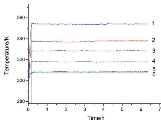
Fig. 4 Temperature versus time for cinnamaldehyde, 1 –  $\text{N}_2$ ,  $353 \text{ K}$ ; 2 –  $\text{O}_2$ ,  $338 \text{ K}$ ; 3 –  $\text{O}_2$ ,  $328 \text{ K}$ ; 4 –  $\text{O}_2$ ,  $318 \text{ K}$ ; 5 –  $\text{O}_2$ ,  $308 \text{ K}$ ; 6 –  $\text{N}_2$ ,  $308 \text{ K}$ .
