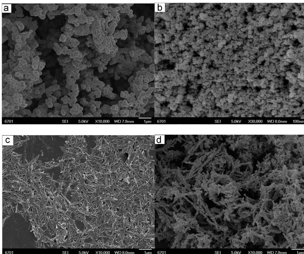
Fig. 2 SEM micrographs of PPY (a),  $\text{Fe}_3\text{O}_4$  (b), ATP (c) and PPY/ $\text{Fe}_3\text{O}_4$ /ATP (d) composite.
