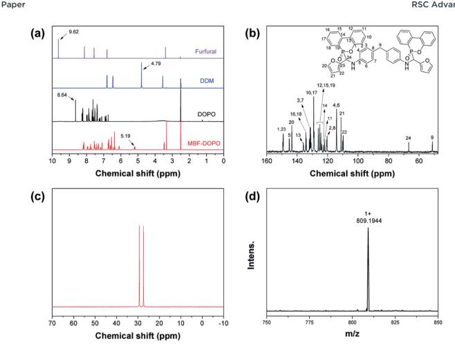
Fig. 3 (a) <sup>1</sup>H NMR spectra of furfural, DDM, DOPO, and MBF-DOPO. (b) <sup>13</sup>C-NMR, (c) <sup>31</sup>P-NMR, and (d) HRESI-MS spectra of MBF-DOPO.
