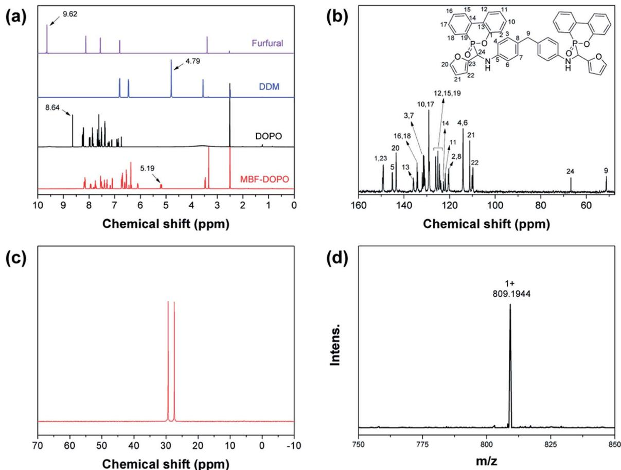
Fig. 3 (a) <sup>1</sup>H NMR spectra of furfural, DDM, DOPO, and MBF-DOPO. (b) <sup>13</sup>C-NMR, (c) <sup>31</sup>P-NMR, and (d) HRESI-MS spectra of MBF-DOPO.
