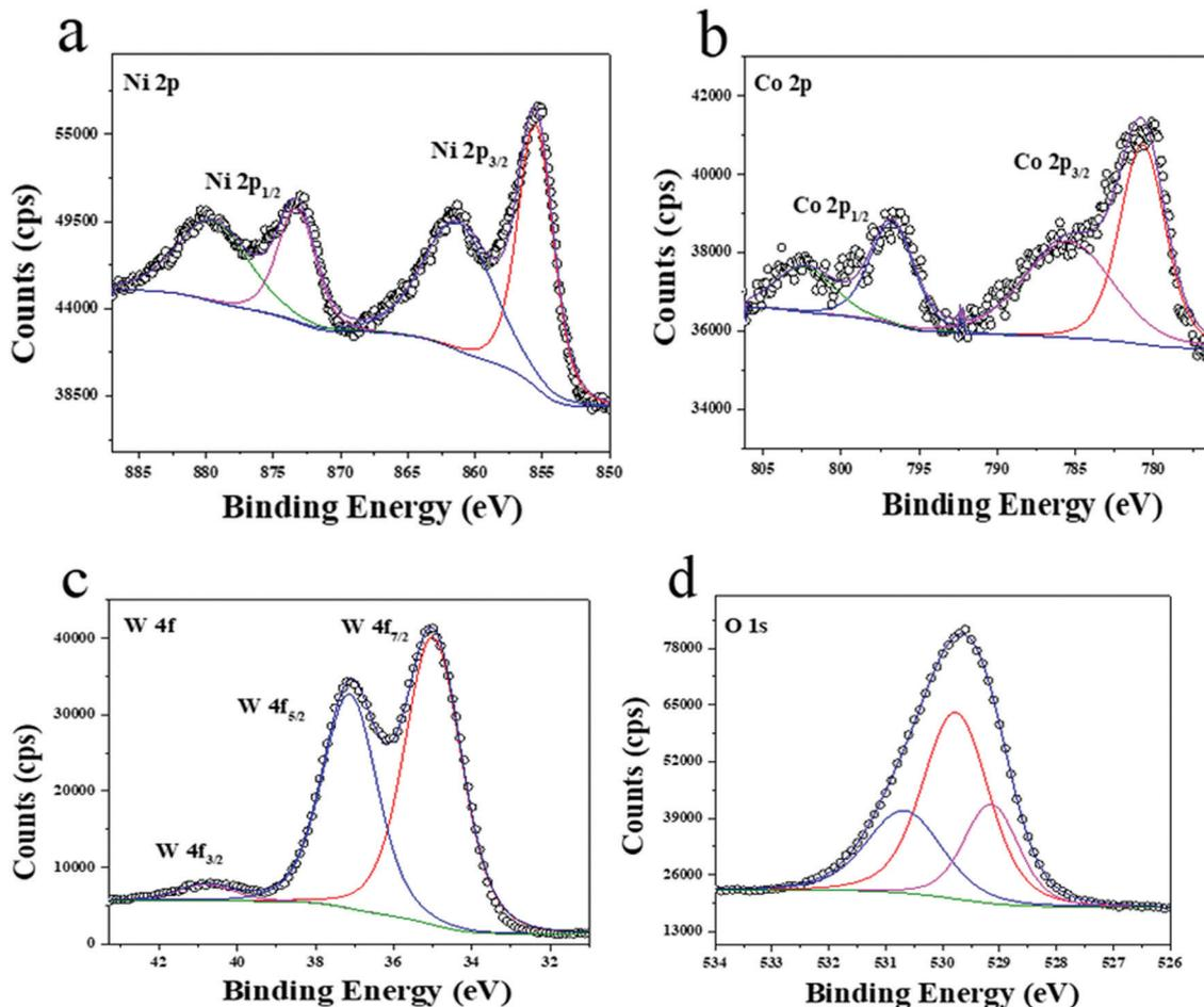
Fig. 5 XPS Spectrum for (a) Ni 2p, (b) Co 2p, (c) W 4f, and (d) O 1s.
