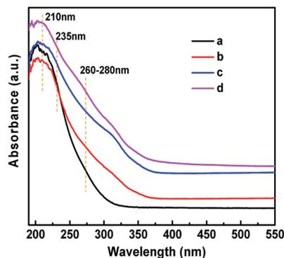
Fig. 3 UV/Vis spectra of the prepared samples. (a) TS-1; (b) H-TS-1; (c) HCS-TS; (d) HCS-TS<sup>P</sup>.
