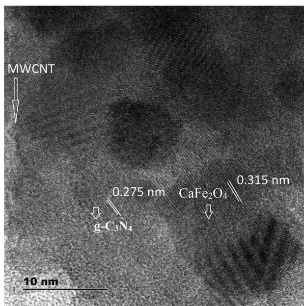
Fig. 6 HRTEM images of the  $\text{CaFe}_2\text{O}_4/g\text{-C}_3\text{N}_4/\text{CNT}$  composite.
