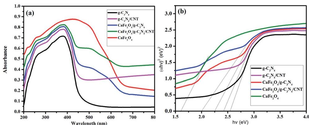
Fig. 2 (a) UV-vis diffuse reflectance spectra of  $\text{CaFe}_2\text{O}_4$ ,  $\text{g-C}_3\text{N}_4$ ,  $\text{g-C}_3\text{N}_4/\text{CNT}$ s, and  $\text{CaFe}_2\text{O}_4/\text{g-C}_3\text{N}_4/\text{CNT}$  composite. (b) Optical band gap energy,  $E_g$ , of  $\text{CaFe}_2\text{O}_4$ ,  $\text{g-C}_3\text{N}_4$ ,  $\text{g-C}_3\text{N}_4/\text{CNT}$ s, and  $\text{CaFe}_2\text{O}_4/\text{g-C}_3\text{N}_4/\text{CNT}$  composite.
