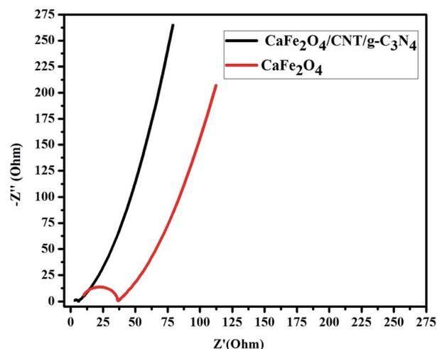
Fig. 10 EIS spectra  $\text{CaFe}_2\text{O}_4$  and  $\text{CaFe}_2\text{O}_4/\text{g-C}_3\text{N}_4/\text{CNT}$  composite.
