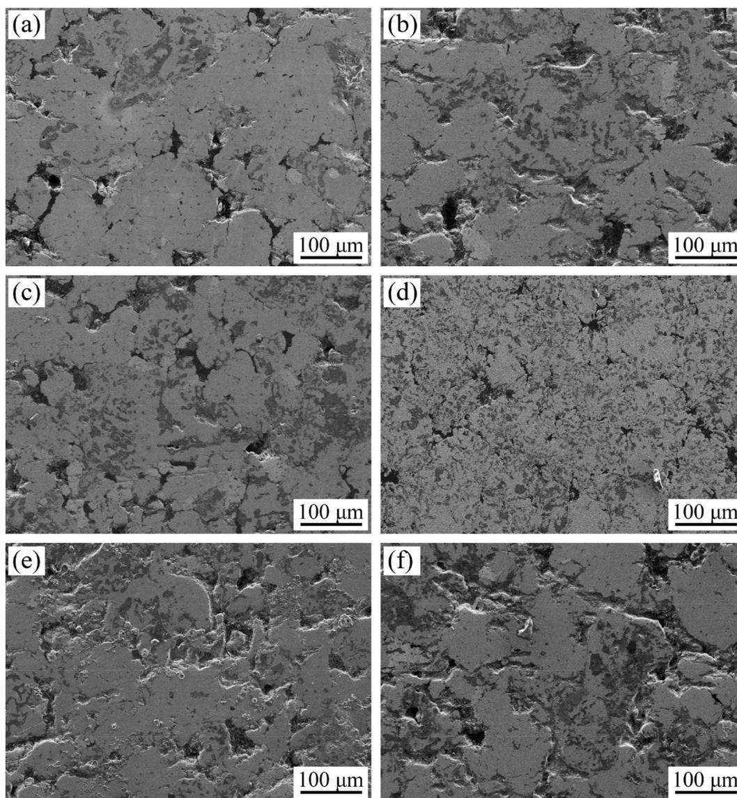
Fig. 7 Microstructure of the sintered specimens with (a) 0.2 wt%  $\text{La}_2\text{O}_3$ , (b) 0.2 wt%  $\text{CeO}_2$ , (c) 0.4 wt%  $\text{La}_2\text{O}_3$ , (d) 0.4 wt%  $\text{CeO}_2$ , (e) 0.6 wt%  $\text{La}_2\text{O}_3$ , (f) 0.6 wt%  $\text{CeO}_2$ .
