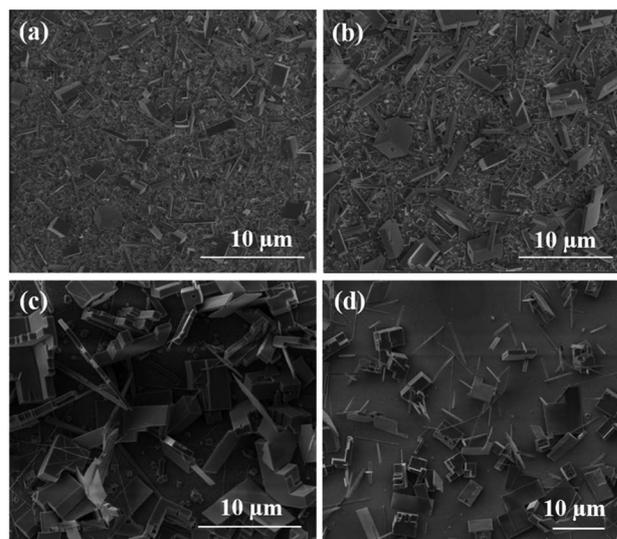
Fig. 1 The SEM images of perovskite  $\text{CH}_3\text{NH}_3\text{PbBr}_3$  nanostructures grown at different concentrations of  $\text{CH}_3\text{NH}_3\text{Br}$  in the isopropanol solution. (a)  $20 \text{ mg mL}^{-1}$ , (b)  $10 \text{ mg mL}^{-1}$ , (c)  $5 \text{ mg mL}^{-1}$ , (d)  $2 \text{ mg mL}^{-1}$ .
