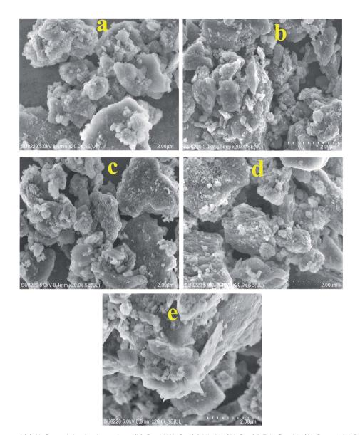
$\label{eq:composition} \textbf{Fig. 2} \quad \text{FESEM images of (a) } \\ \text{Al}_2O_3 \text{ and the fresh catalysts (b) } \\ \text{Co-M/Al}_2O_3, \text{ (c) Ni-Mo/Al}_2O_3, \text{ (d) Pd-Co-Mo/Al}_2O_3 \text{ and (e) Pd-Ni-Mo/Al}_2O_3. \\ \text{Co-Mo/Al}_2O_3, \text{ (d) Pd-Co-Mo/Al}_2O_3, \text{ (d) Pd-Co-Mo/Al}_2O_3, \text{ (d) Pd-Ni-Mo/Al}_2O_3, \text$
