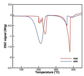
Fig. 17 DSC data of biuret (cylinder crucible).
