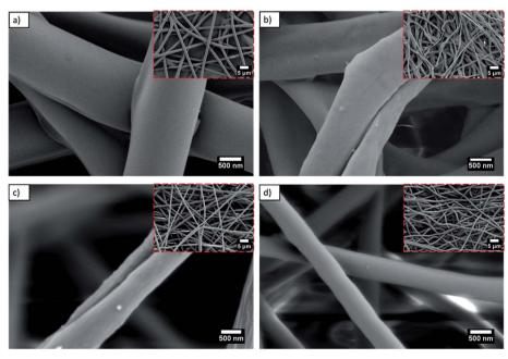
Fig. 1 SEM images of electrospun fibers 5000× (red squares) and 50 000×. (a) PLLA (b) PLLA HT (c) PLLA + SV (d) PLLA + SV HT.
