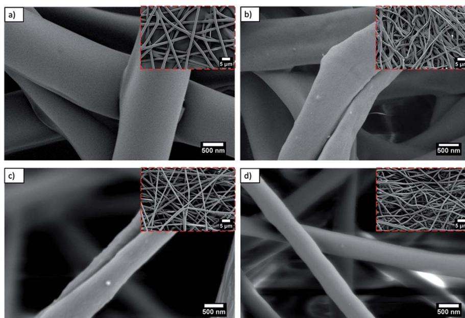
Fig. 1 SEM images of electrospun fibers 5000 $\times$  (red squares) and 50 000 $\times$ . (a) PLLA (b) PLLA HT (c) PLLA + SV (d) PLLA + SV HT.
