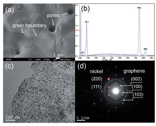
Fig. 1 (a) SEM image, (b) EDS, (c) TEM image and (d) corroding SAED of G-Ni-3 sample.
