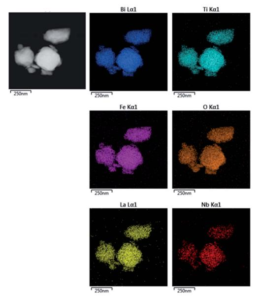
Fig. 4 TEM-EDS images of Bi<sub>3</sub>LaTiNbFeO<sub>12</sub>-Bi<sub>5</sub>Ti<sub>3</sub>FeO<sub>15</sub> (BLTNF-3.5).
