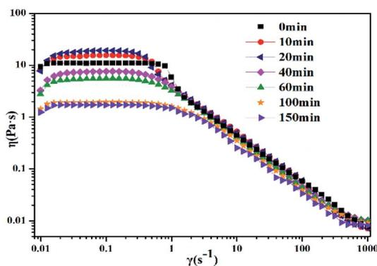
Fig. 5 Effect of UV irradiation time (0 min, 10 min, 20 min, 40 min, 60 min, 100 min, and 150 min) on steady shear viscosity for 30 mM  $12\text{-}2\text{-}12\cdot 2\text{Br}^-/10\text{ mM } trans\text{-OMCA}$  system at 25 °C.
