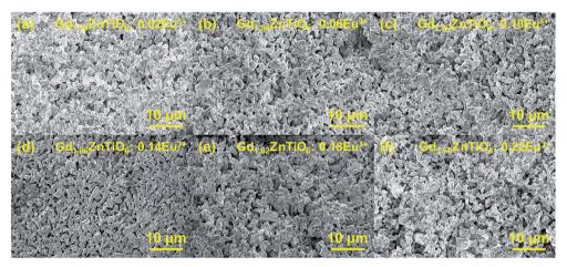
Fig. 2 Surface morphologies of the  $Gd_{2-2x}ZnTiO_6$ :  $2xEu^{3+}$  ( $x=(a)\ 0.01$ , (b) 0.03, (c) 0.05, (d) 0.07, (e) 0.09, and (f) 0.11) phosphors.
