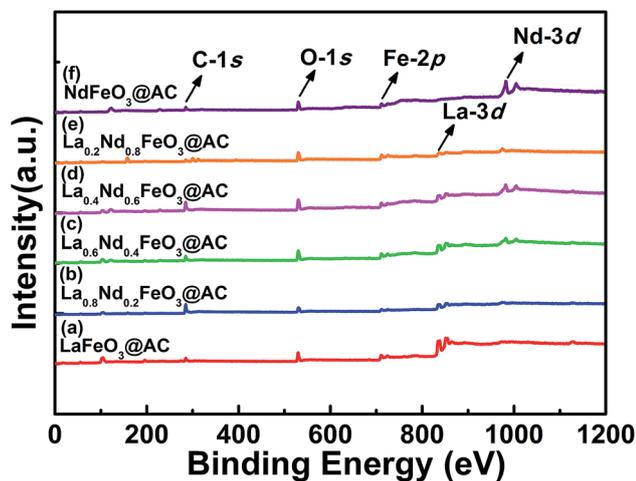
Fig. 4 Survey XPS spectrum of perovskite catalysts: (a)  $\text{LaFeO}_3\text{@AC}$ ; (b)  $\text{La}_{0.8}\text{Nd}_{0.2}\text{FeO}_3\text{@AC}$ ; (c)  $\text{La}_{0.6}\text{Nd}_{0.4}\text{FeO}_3\text{@AC}$ ; (d)  $\text{La}_{0.4}\text{Nd}_{0.6}\text{FeO}_3\text{@AC}$ ; (e)  $\text{La}_{0.2}\text{Nd}_{0.8}\text{FeO}_3\text{@AC}$ ; (f)  $\text{NdFeO}_3\text{@AC}$ .
