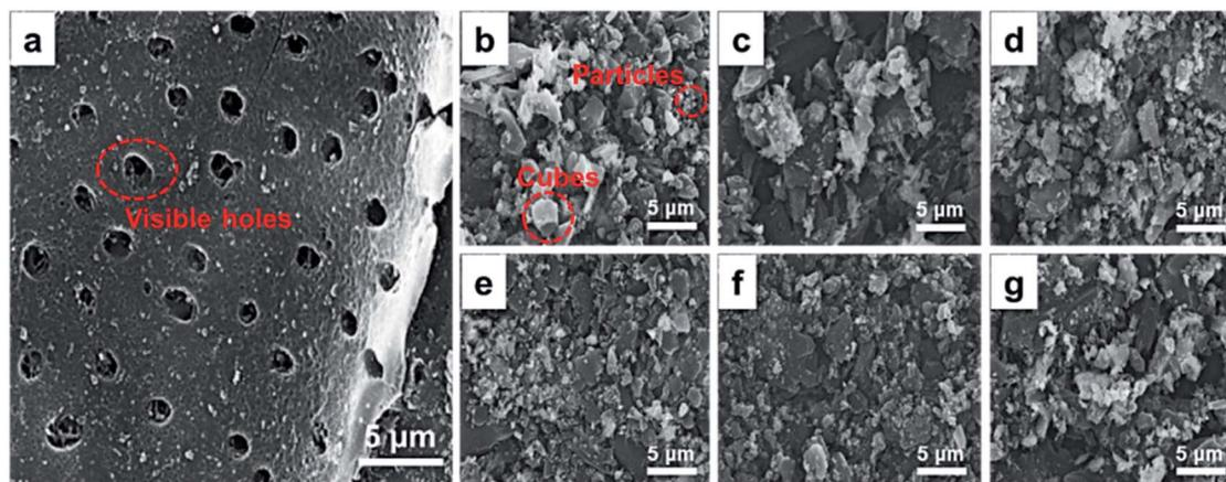
Fig. 2 SEM images of (a) modified AC; (b)  $\text{LaFeO}_3@\text{AC}$ ; (c)  $\text{La}_{0.8}\text{Nd}_{0.2}\text{FeO}_3@\text{AC}$ ; (d)  $\text{La}_{0.6}\text{Nd}_{0.4}\text{FeO}_3@\text{AC}$ ; (e)  $\text{La}_{0.4}\text{Nd}_{0.6}\text{FeO}_3@\text{AC}$ ; (f)  $\text{La}_{0.2}\text{Nd}_{0.8}\text{FeO}_3@\text{AC}$ ; (g)  $\text{NdFeO}_3@\text{AC}$ .
