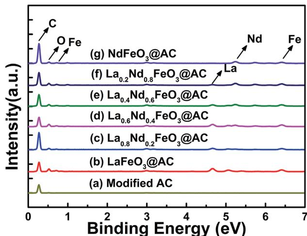
Fig. 3 EDS of (a) modified AC; (b)  $\text{LaFeO}_3\text{@AC}$ ; (c)  $\text{La}_{0.8}\text{Nd}_{0.2}\text{FeO}_3\text{@AC}$ ; (d)  $\text{La}_{0.6}\text{Nd}_{0.4}\text{FeO}_3\text{@AC}$ ; (e)  $\text{La}_{0.4}\text{Nd}_{0.6}\text{FeO}_3\text{@AC}$ ; (f)  $\text{La}_{0.2}\text{Nd}_{0.8}\text{FeO}_3\text{@AC}$ ; (g)  $\text{NdFeO}_3\text{@AC}$ .
