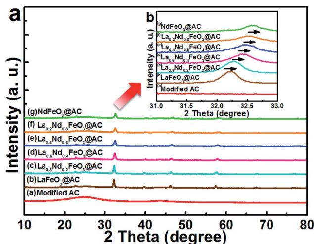
Fig. 1 XRD energy spectra of (a) modified AC; (b)  $\text{LaFeO}_3/\text{AC}$ ; (c)  $\text{La}_{0.8}\text{Nd}_{0.2}\text{FeO}_3/\text{AC}$ ; (d)  $\text{La}_{0.6}\text{Nd}_{0.4}\text{FeO}_3/\text{AC}$ ; (e)  $\text{La}_{0.4}\text{Nd}_{0.6}\text{FeO}_3/\text{AC}$ ; (f)  $\text{La}_{0.2}\text{Nd}_{0.8}\text{FeO}_3/\text{AC}$ ; (g)  $\text{NdFeO}_3/\text{AC}$ .
