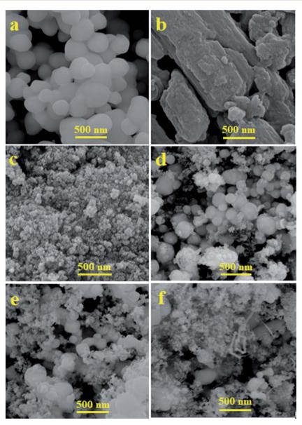
Fig. 4 FE-SEM images of (a) APO, (b) C<sub>60</sub>, (c) Fe<sub>3</sub>O<sub>4</sub>, (d) m-APO/C<sub>60</sub>(5), (e) m-APO/C<sub>60</sub>(10) and (f) m-APO/C<sub>60</sub>(20).
