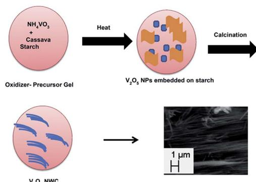
Fig. 4 Illustration of  $\text{V}_2\text{O}_5$  NWC formation.<sup>69</sup>
