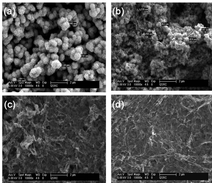
Fig. 1 SEM images of the grown MoS<sub>2</sub>/rGO with the ratio (a) (1 : 0), (b) (1 : 1), (c) (1 : 2) and (d) (1 : 3).
