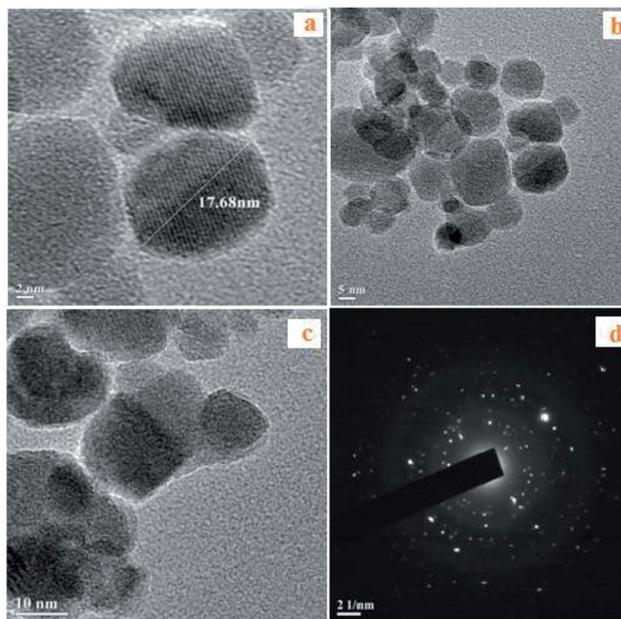
Fig. 3 (a) HRTEM images of  $\text{Fe}_3\text{O}_4$  nanoparticles, (b) HRTEM images of  $\text{Fe}_3\text{O}_4$ @ $\text{SiO}_2$ , (c) HRTEM images of  $\text{Fe}_3\text{O}_4$ @ $\text{SiO}_2$ @ $\text{SO}_3\text{H}$ , (d) ED pattern of  $\text{Fe}_3\text{O}_4$ @ $\text{SiO}_2$ @ $\text{SO}_3\text{H}$ .
