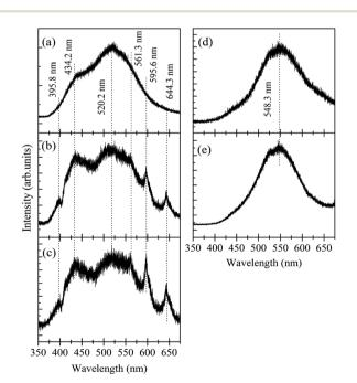
Fig. 7 Room temperature PL spectra of (a) pure  $\gamma$ -Ga<sub>2.67</sub>O<sub>4</sub>, (b)  $\gamma$ - $Ga_{2.67}O_4$ : 5Sm, (c)  $\gamma$ - $Ga_{2.67}O_4$ : 10Sm, (d)  $Ga_2O_3$ \_600 and (e) Ga<sub>2</sub>O<sub>3</sub>\_900 samples.
