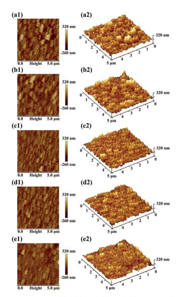
Fig. 6 AFM images of (a) PA, (b) MM-3h, (c) MM-6h, (d) MM-12h and (e) MM-COOH membranes.
