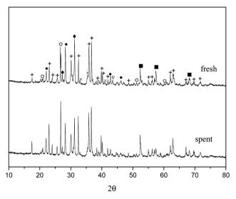
Fig. 15 XRD patterns of fresh and spent TF-Ni/olivine catalysts +:  $Mg_2SiO_4$ ;  $\bullet$ :  $MgSiO_3$ ;  $\bigcirc$ : (Fe,Ni);  $\times$ :  $Fe_2O_3$ ;  $\bullet$ :  $(Mg,Fe)SiO_3$ ;  $\nabla$ : Ni;  $\blacksquare$ :  $(Ni,Mg)_2SiO_4$ .
