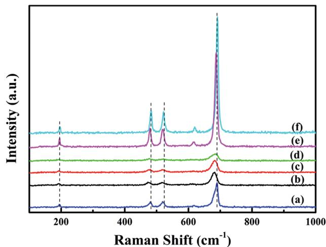
Fig. 5 Raman spectra of (a) meso- $\text{Co}_3\text{O}_4$ , (b) 0.3Pt/meso- $\text{Co}_3\text{O}_4$ , (c) 0.6Pt/meso- $\text{Co}_3\text{O}_4$ , (d) 1.0Pt/meso- $\text{Co}_3\text{O}_4$ , (e) 0.6Pt/bulk- $\text{Co}_3\text{O}_4$  and (f) bulk- $\text{Co}_3\text{O}_4$ .
