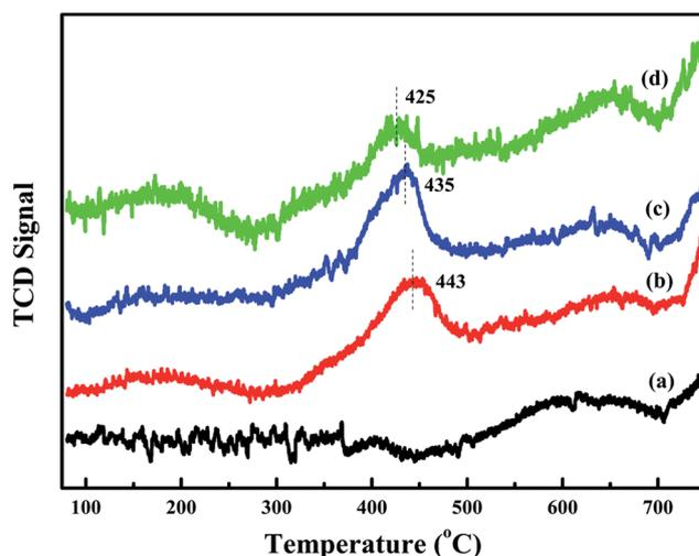
Fig. 7 O<sub>2</sub>-TPD profiles of (a) meso-Co<sub>3</sub>O<sub>4</sub>, (b) 0.3Pt/meso-Co<sub>3</sub>O<sub>4</sub>, (c) 0.6Pt/meso-Co<sub>3</sub>O<sub>4</sub> and (d) 1.0Pt/meso-Co<sub>3</sub>O<sub>4</sub>.
