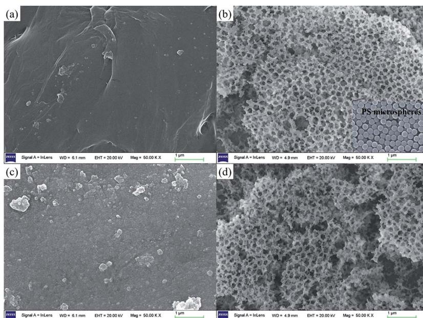
Fig. 4 SEM images of (a) bare-LTO, (b) porous-LTO, (c) bare-HTO, and (d) porous-HTO.
