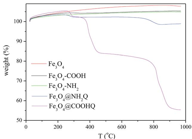
Fig. 5 TG analyses of  $\text{Fe}_3\text{O}_4$ ,  $\text{Fe}_3\text{O}_4\text{-COOH}$ ,  $\text{Fe}_3\text{O}_4\text{-NH}_2$ ,  $\text{Fe}_3\text{O}_4\text{@NH}_2\text{Q}$  and  $\text{Fe}_3\text{O}_4\text{@COOHQ}$ .
