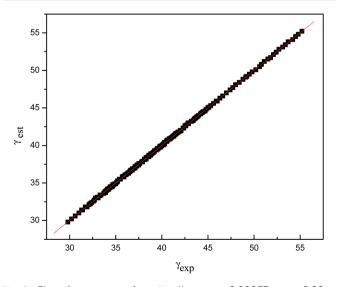
Fig. 6 Plot of  $\gamma_{\rm est}$  vs.  $\gamma_{\rm exp}$  for other ILs.  $\gamma_{\rm est}=0.99957\gamma_{\rm exp}-2.02\times10^{-2}$ ; r=0.99,  $s=5.82\times10^{-2}$ .
