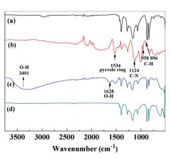
Fig. 2 FT-IR spectra of (a) PVDF/TBAC, (b) PVDF/TBAC-PPy, (c) PVDF/TBAC-PPy-MnO $_2$  and (d) PVDF/TBAC-MnO $_2$  nanofiber mat.
