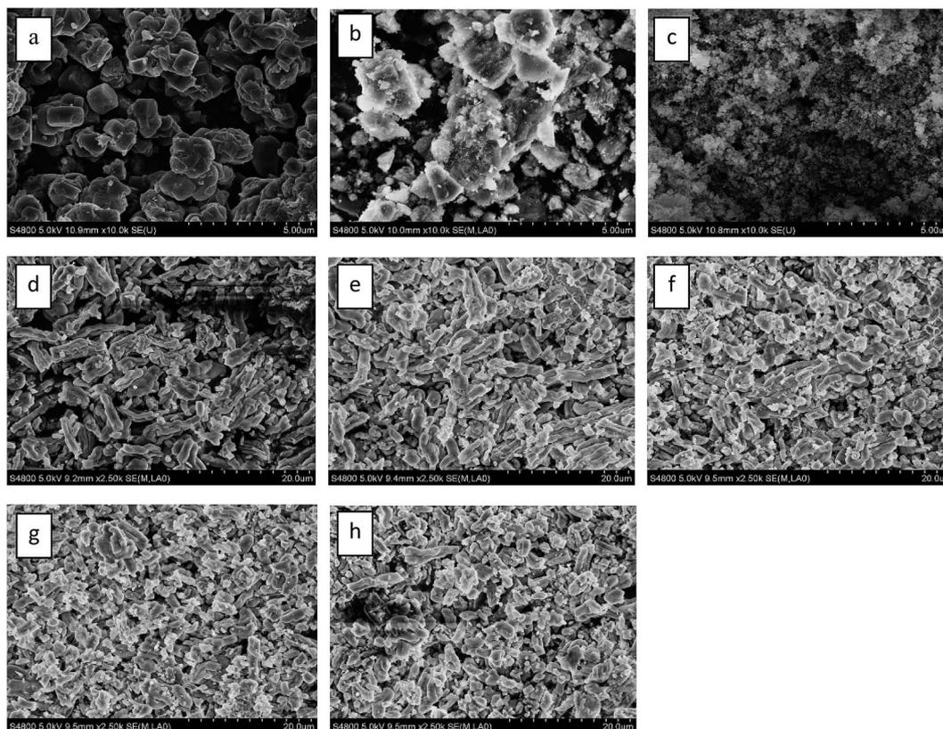
Fig. 3 FESEM images of (a)  $5\text{Ga}_2\text{O}_3/\text{ZSM-5}$ ; (b)  $5\text{Ga}_2\text{O}_3/\text{Al}_2\text{O}_3$ ; (c)  $5\text{Ga}_2\text{O}_3/\text{SiO}_2$ ; (d)  $1\text{Ga}_2\text{O}_3/\text{SBA-15}$ ; (e)  $3\text{Ga}_2\text{O}_3/\text{SBA-15}$ ; (f)  $5\text{Ga}_2\text{O}_3/\text{SBA-15}$ ; (g)  $7\text{Ga}_2\text{O}_3/\text{SBA-15}$ ; (h)  $9\text{Ga}_2\text{O}_3/\text{SBA-15}$ .
