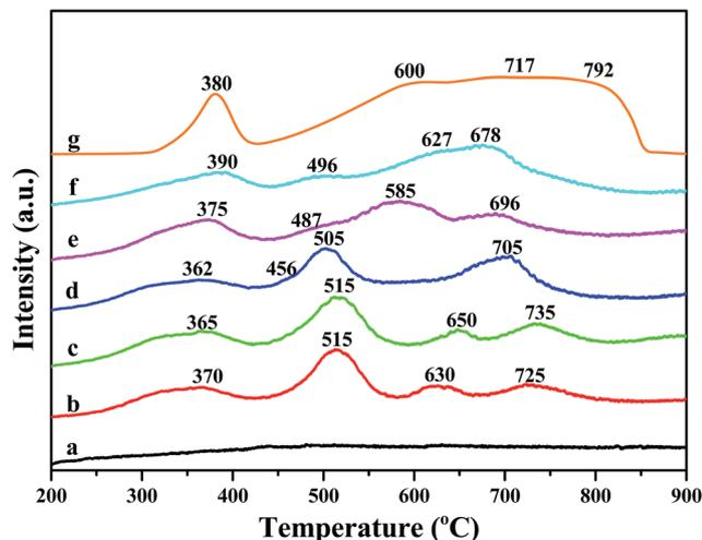
Fig. 7  $\text{H}_2$ -TPR profiles of H-beta (a); Fe/beta (b);  $\text{Mo}_{0.1}$ -Fe/beta (c);  $\text{Mo}_{0.2}$ -Fe/beta (d);  $\text{Mo}_{0.5}$ -Fe/beta (e);  $\text{Mo}_1$ -Fe/beta (f);  $\alpha\text{-Fe}_2\text{O}_3$  (g).
