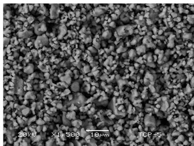
Fig. 6 LV-SEM image of the  $\beta$ -TCP.
