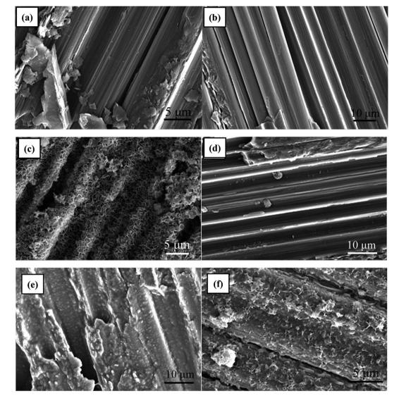
SEM images of (a) C/C, (b) C/C-OH, (c) C/C + HAP, (d) C/C-APTMS, (e) C/C + CS, (f) C/C + CS/HAP
