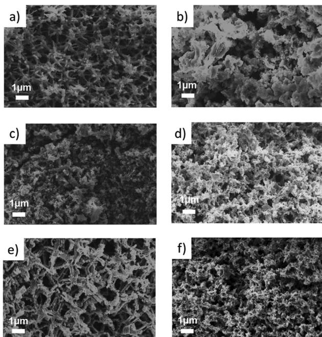
Fig. 4 SEM images of  $\text{Mg}_2\text{Si}$  samples with different reaction holding times and temperatures: (a)  $650\text{ }^\circ\text{C} - 2\text{ h}$ ; (b)  $650\text{ }^\circ\text{C} - 5\text{ h}$ ; (c)  $600\text{ }^\circ\text{C} - 2\text{ h}$ ; (d)  $600\text{ }^\circ\text{C} - 5\text{ h}$ ; (e)  $700\text{ }^\circ\text{C} - 30\text{ min}$ ; (f)  $700\text{ }^\circ\text{C} - 2\text{ h}$ .
