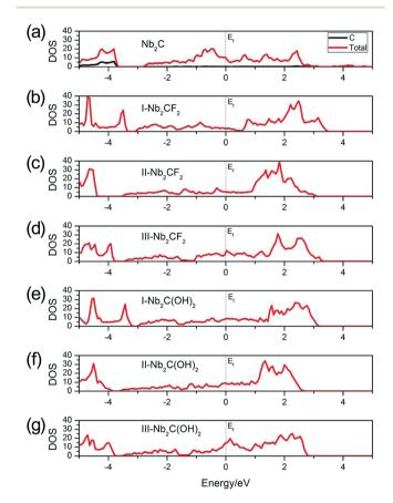
Fig. 2 Total DOS of (a) Nb $_2$ C, (b) I-Nb $_2$ CF $_2$ , (c) II-Nb $_2$ CF $_2$ , (d) III-Nb $_2$ CF $_2$ , (e) I-Nb $_2$ C(OH) $_2$ , (f) II-Nb $_2$ C(OH) $_2$  and (g) III-Nb $_2$ C(OH) $_2$ . The Fermi levels are set to zero.
