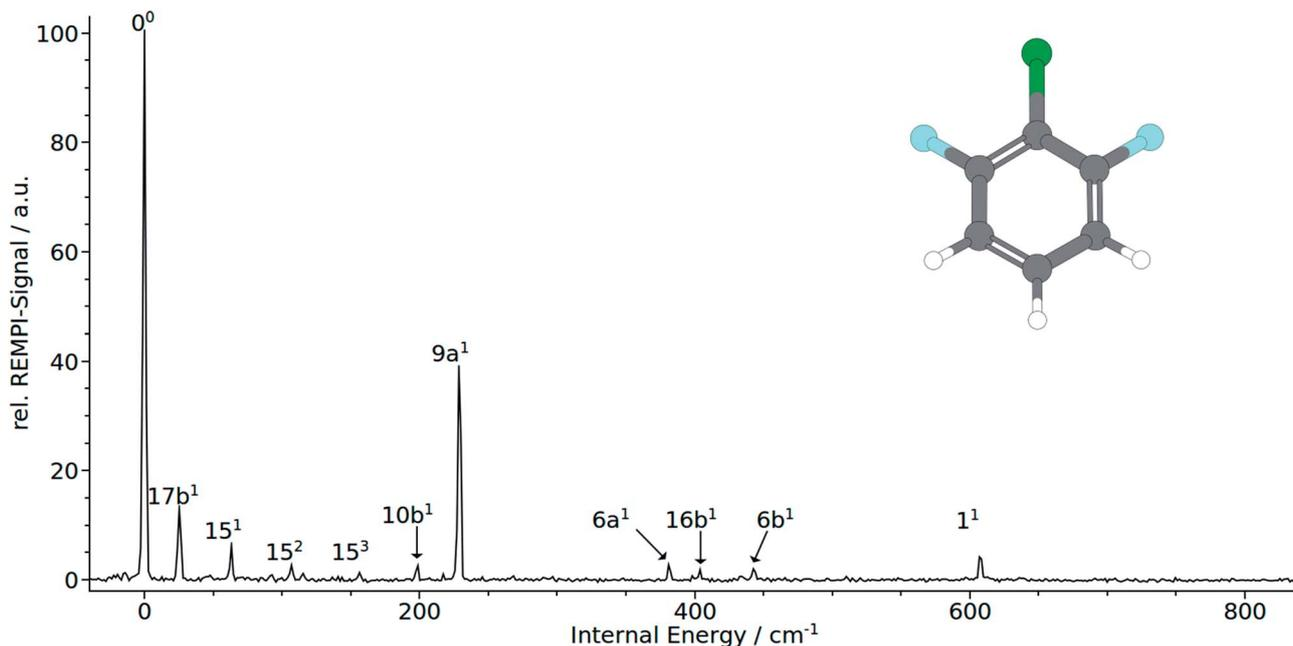
Fig. 3  $(1 + 1')$  REMPI spectrum of 1,3-difluoro-2-chloro-benzene (1,3,2-DFCB).
