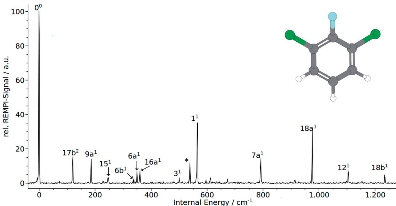
Fig. 1  $(1 + 1')$  REMPI spectrum of 1,3-dichloro-2-fluoro-benzene (1,3,2-DCFB).
