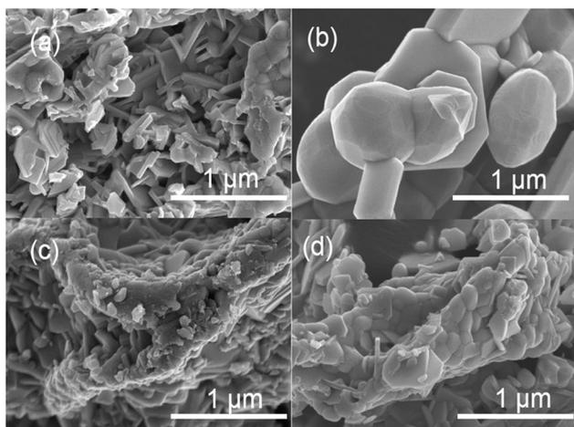
Fig. 2 SEM images of (a)  $\text{Sm}_2\text{Ti}_2\text{S}_2\text{O}_5$ , (b)  $\text{Sm}_2\text{Ti}_2\text{S}_2\text{O}_5$  (S), (c)  $\text{Sm}_2\text{Ti}_2\text{S}_2\text{O}_5$  ( $\text{HNO}_3$ ), and (d)  $\text{Sm}_2\text{Ti}_2\text{S}_2\text{O}_5$  (S +  $\text{HNO}_3$ ).
