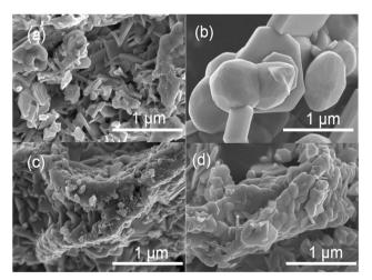
Fig. 2 SEM images of (a)  $Sm_2Ti_2S_2O_5$ , (b)  $Sm_2Ti_2S_2O_5$  (S), (c)  $Sm_2Ti_2S_2O_5$  (HNO<sub>3</sub>), and (d)  $Sm_2Ti_2S_2O_5$  (S + HNO<sub>3</sub>).
