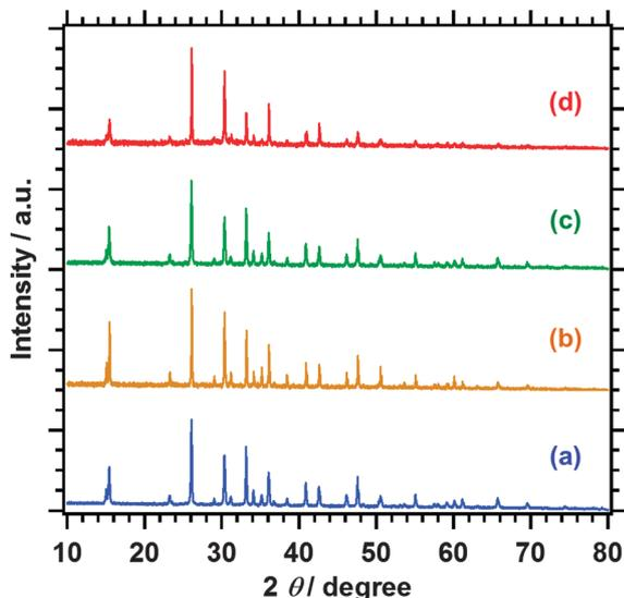
Fig. 1 XRD patterns of (a)  $\text{Sm}_2\text{Ti}_2\text{S}_2\text{O}_5$ , (b)  $\text{Sm}_2\text{Ti}_2\text{S}_2\text{O}_5$  (S), (c)  $\text{Sm}_2\text{Ti}_2\text{S}_2\text{O}_5$  ( $\text{HNO}_3$ ), and (d)  $\text{Sm}_2\text{Ti}_2\text{S}_2\text{O}_5$  (S +  $\text{HNO}_3$ ).
