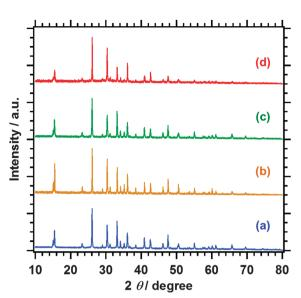
Fig. 1 XRD patterns of (a)  $Sm_2Ti_2S_2O_5$ , (b)  $Sm_2Ti_2S_2O_5$  (S), (c)  $Sm_2Ti_2S_2O_5$  (HNO<sub>3</sub>), and (d)  $Sm_2Ti_2S_2O_5$  (S + HNO<sub>3</sub>).
