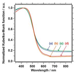
Fig. 3 UV-vis DRS of (a)  $Sm_2Ti_2S_2O_5$ , (b)  $Sm_2Ti_2S_2O_5$  (S), (c)  $Sm_2Ti_2S_2O_5$  (HNO<sub>3</sub>), and (d)  $Sm_2Ti_2S_2O_5$  (S + HNO<sub>3</sub>).
