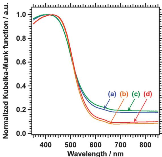
Fig. 3 UV-vis DRS of (a)  $\text{Sm}_2\text{Ti}_2\text{S}_2\text{O}_5$ , (b)  $\text{Sm}_2\text{Ti}_2\text{S}_2\text{O}_5$  (S), (c)  $\text{Sm}_2\text{Ti}_2\text{S}_2\text{O}_5$  ( $\text{HNO}_3$ ), and (d)  $\text{Sm}_2\text{Ti}_2\text{S}_2\text{O}_5$  (S +  $\text{HNO}_3$ ).
