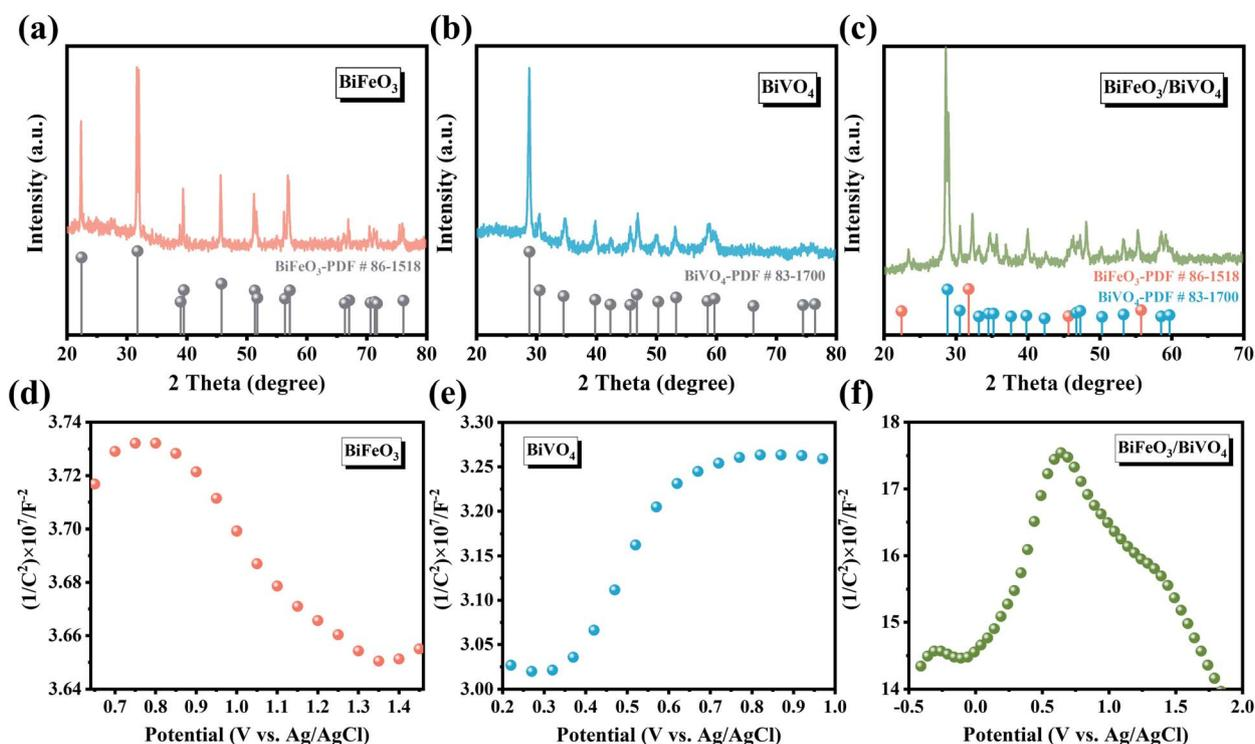
Fig. 3 XRD patterns of (a) BiFeO<sub>3</sub>, (b) BiVO<sub>4</sub> and (c) BiFeO<sub>3</sub>/BiVO<sub>4</sub>; Mott-Schottky plots of (d) BiFeO<sub>3</sub>, (e) BiVO<sub>4</sub> and (f) BiFeO<sub>3</sub>/BiVO<sub>4</sub>.
