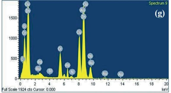
Fig. 3 (a-c) TEM and (d) HRTEM images, (e) an SAED pattern, (f) the particle size distribution and (g) the EDX spectrum of the GO/LDH@AuPd nanocomposite.
