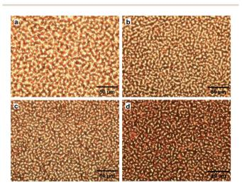
Fig. 4 OM images of  $CH_3NH_3Pbl_3(Cl)$  cells containing (a) 0 mg, (b) 1 mg, (c) 3 mg, and (d) 5 mg of  $NH_4Cl$ .
