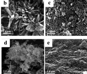
Fig. 5 SEM images of (a) MCM-41, (b) SCO-1, (c) SCO-1@MCM, (d) SCO-2 and (e) SCO-2@MCM.
