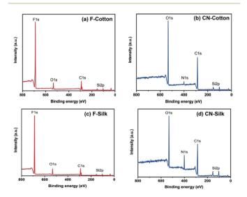
Fig. 4 XPS spectra of (a) F-cotton, (b) CN-cotton, (c) F-silk and (d) CN-silk.
