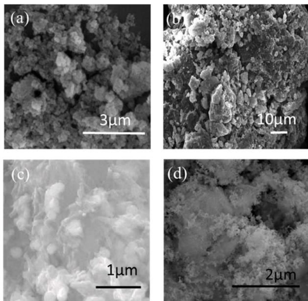
Fig. 3 SEM images of (a) nZVI-red mud;<sup>46</sup> (b) nZVI-zeolite;<sup>44</sup> (c) nZVI-attapulgite (ATP);<sup>47</sup> (d) nZVI bentonite.<sup>49</sup>
