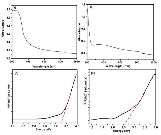
UV-visible-NIR absorption spectra of (a) spiky MMO and (b) MMO-Aq. Tauc plots of (c) spiky MMO and (d) MMO-Aq
