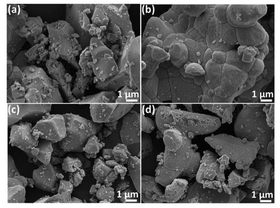
Fig. 3 SEM images for (a) 0 mol% of Dy<sup>3+</sup> (b) 1 mol% of Dy<sup>3+</sup> (c) 5 mol% of Dy<sup>3+</sup> (d) 7 mol% of Dy<sup>3+</sup> in BaLa<sub>2</sub>ZnO<sub>5</sub> phosphor material.
